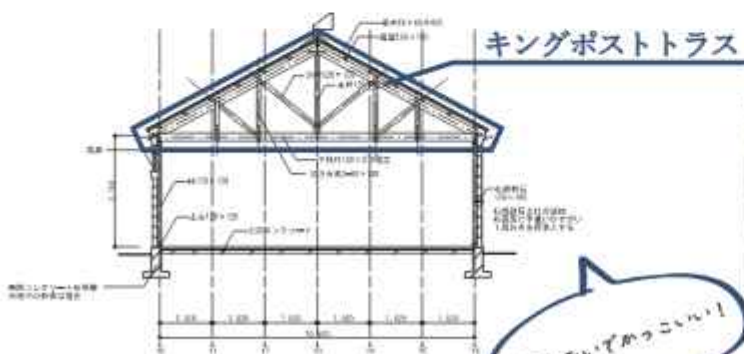
▲木骨石造倉庫の断面図
